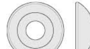
85421 ● Cone Washer 15x5x5mm Senkkopfunterlagscheiben 15x5x5mm Rondelle conique 15x5x5mm コーンワッシャー 15x5x5mm
